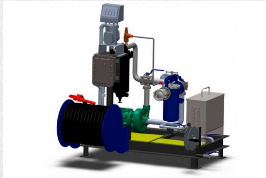
SKID DE DESCARGA E ABASTECIMENTO AVIAÇÃO
