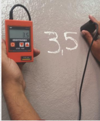
MEDIÇÃO DA ESPESSURA
